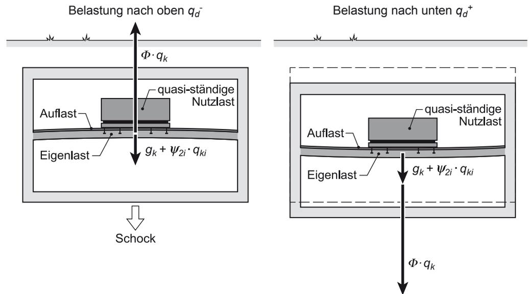
Abbildung 34 Schockbelastung von Zwischendecken
