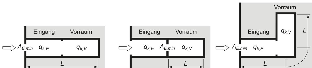
Abbildung 27 Konfigurationen von geschützten Eingangsbauwerken mit Korridoren
