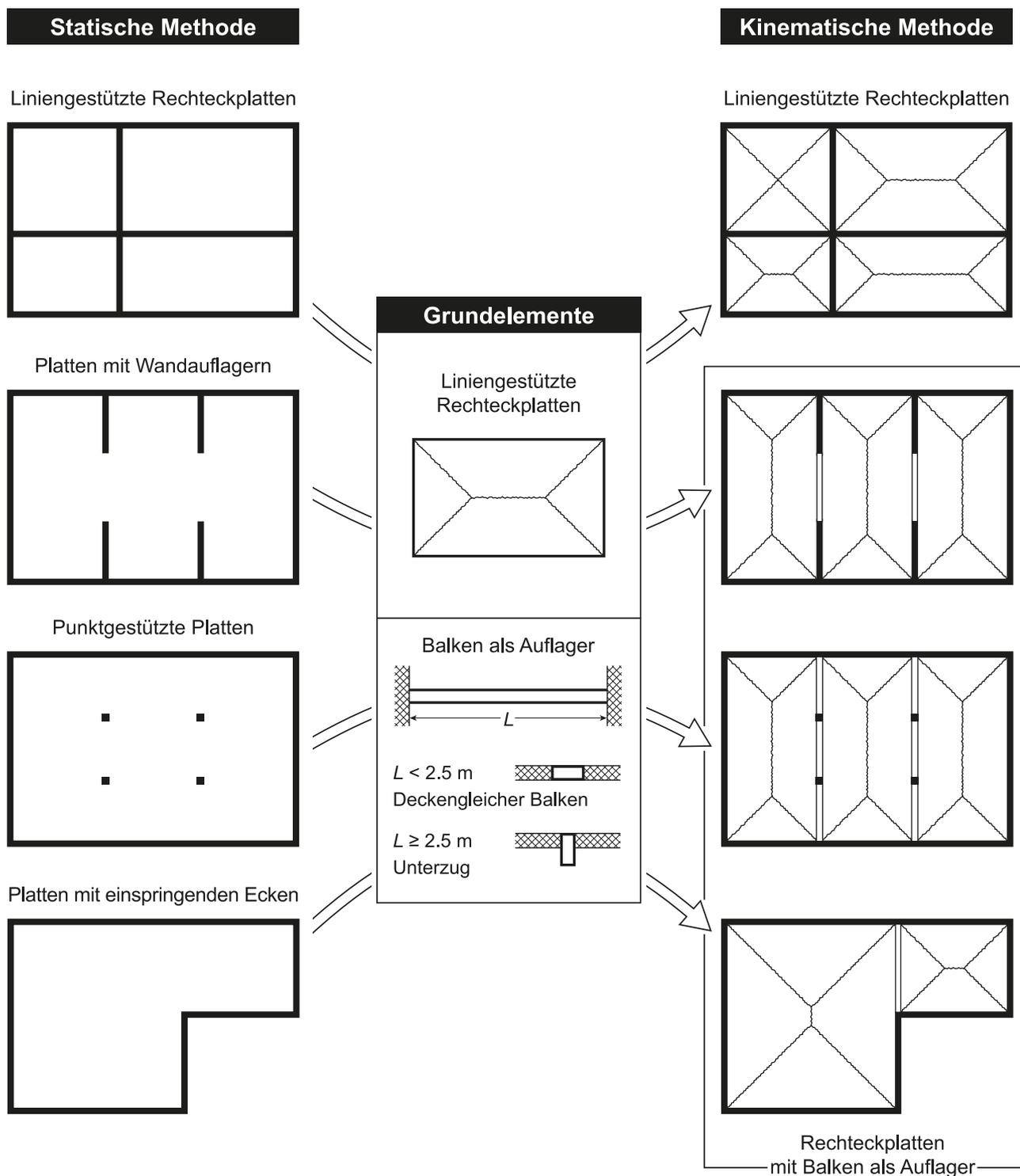
Abbildung 5 Übersicht über Tragsysteme und Methoden der Tragwerksanalyse
