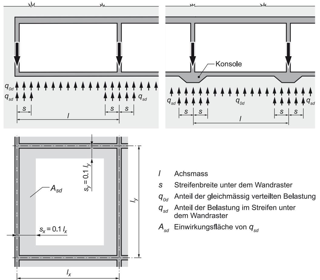
Abbildung 20 Einwirkungen auf die Bodenplatte bei einem Wandraster
