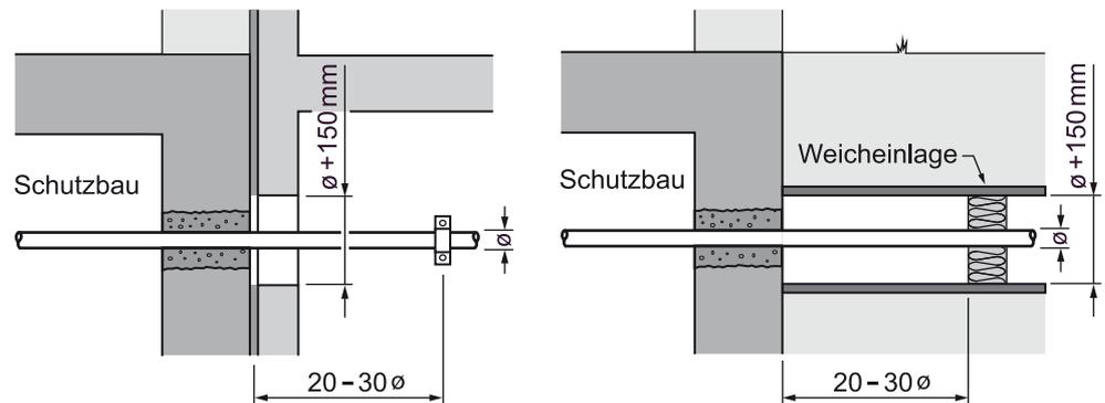
Abbildung 50 Leitungseinführungen
