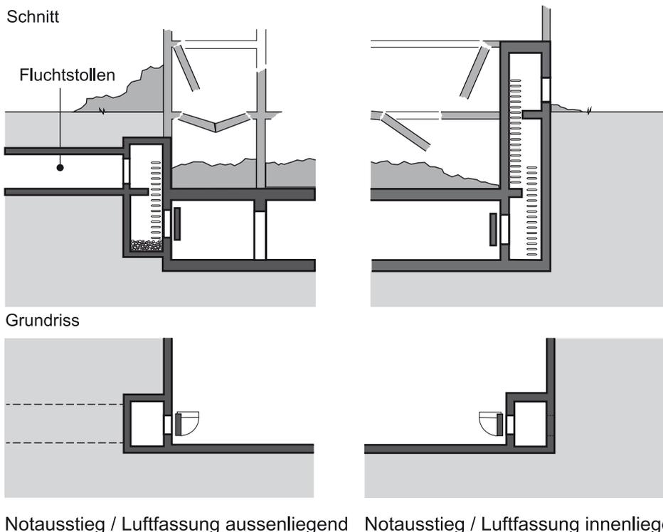
Abbildung 32 Notausgänge von Schutzbauten unter mehreren ungeschützten Untergeschossen
