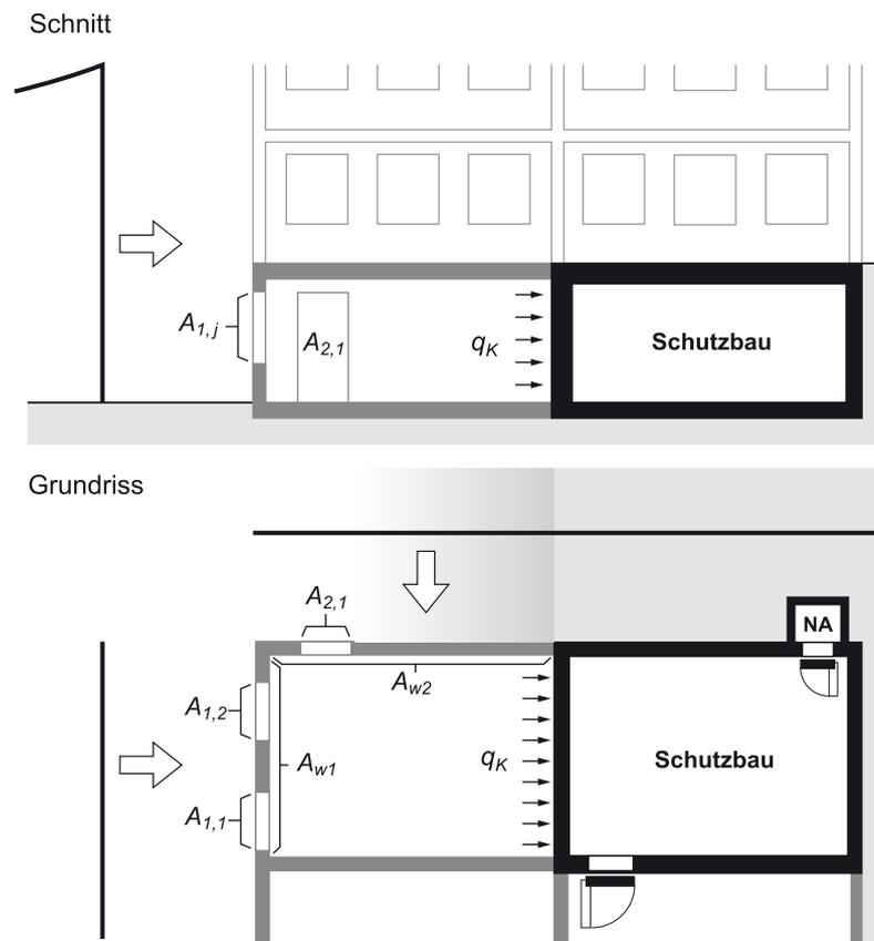
Abbildung 23 Beispiel der Bestimmung der Einwirkung infolge Luftstoss auf eine Schutzbauaussenwand gegen einen ungeschützten Vorraum
