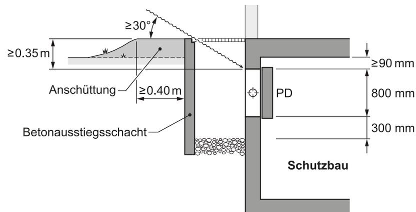
Abbildung 16 Anordnung von Notausstiegen nahe der Terrainoberfläche
