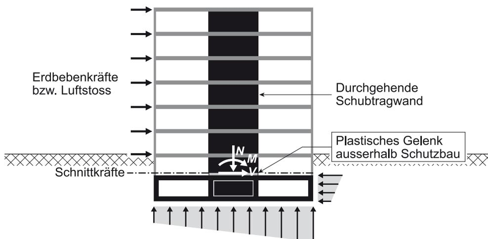
Abbildung 4 Kapazitätsbemessung einer Schubtragwand für Erdbeben- bzw. Luftstossbelastung
