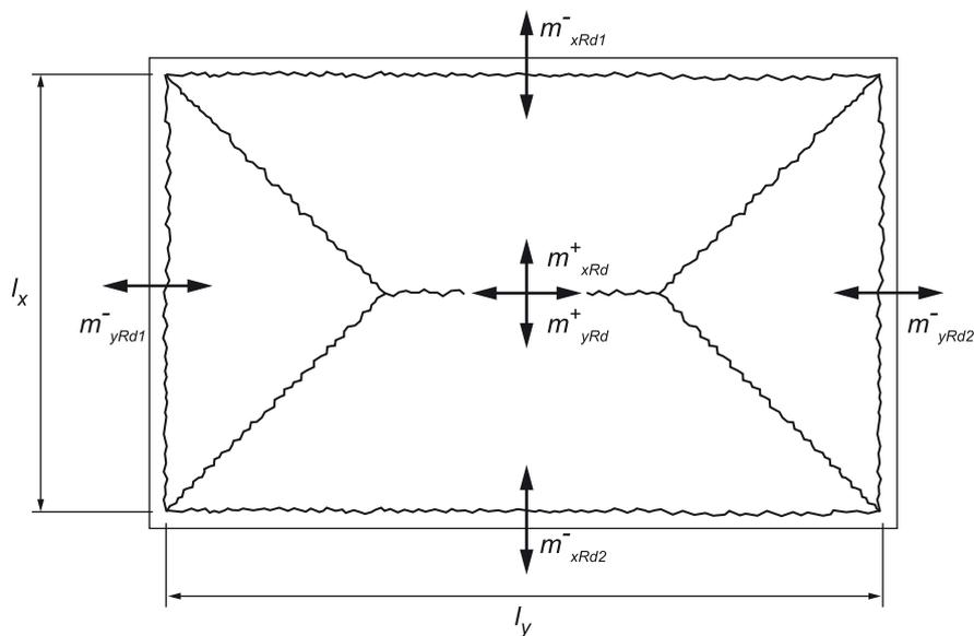
Abbildung 35 Bruchlinien einer allseitig eingespannten Rechteckplatte mit Bezeichnungen der Biegewiderstände
