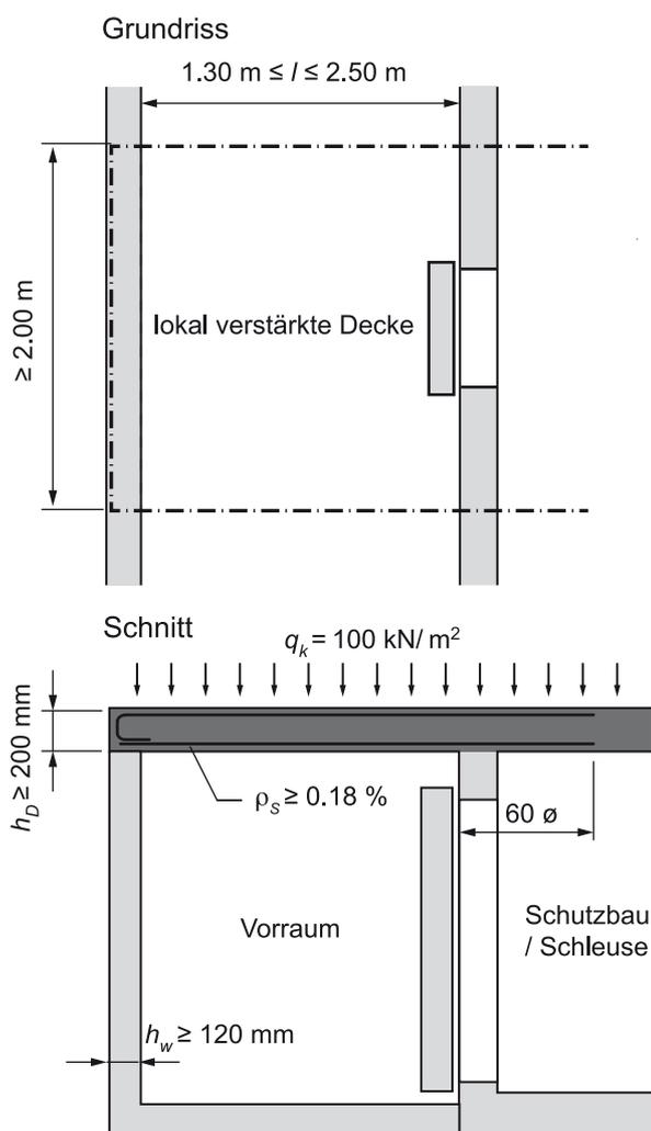
Abbildung 62 Verstärkte Decke als Trümmerschutzbau des Schutzbaueingangs (Plattenstreifen über dem ungeschützten Vorraum)
