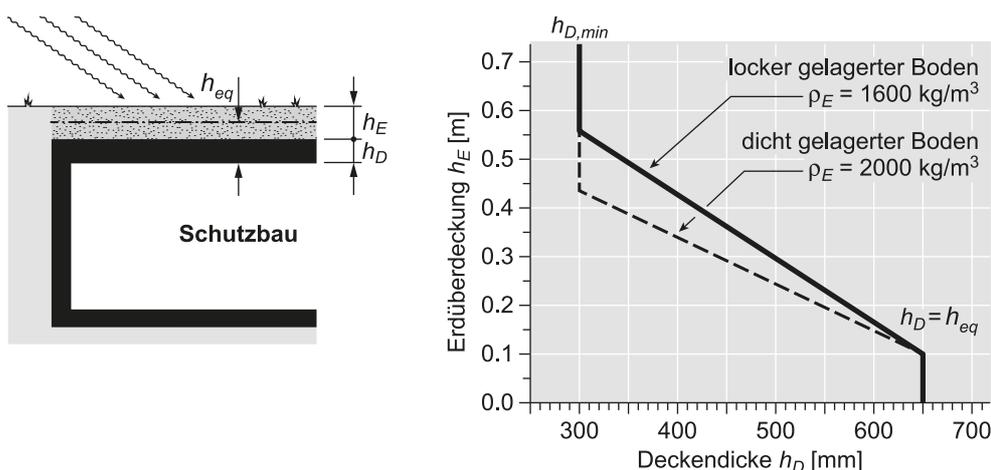
Abbildung 7: Deckendicke für erdüberdeckte Decken im Freien
