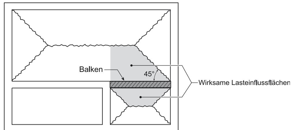
Abbildung 40 Balken als Plattenaufleger bei einer einspringenden Ecke
