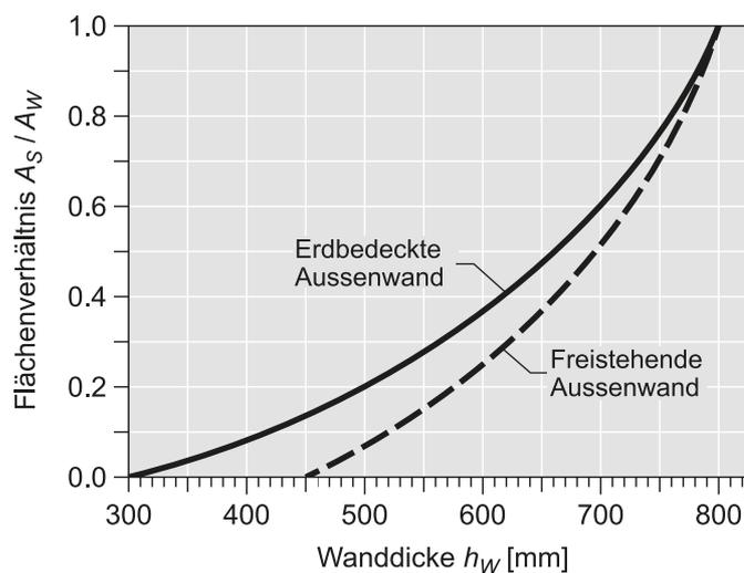
Abbildung 10: Wanddicke von Aussenwänden
