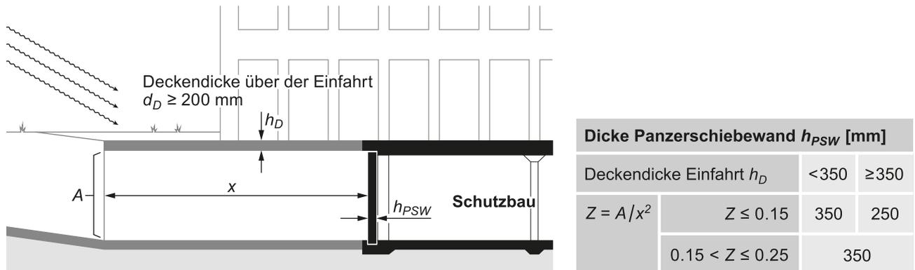
Abbildung 15 Dicke der Panzerschiebewand von Schutzräumen in Tiefgaragen
