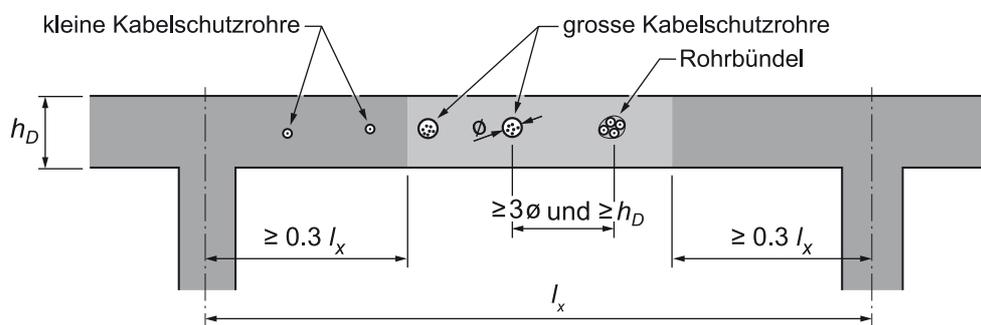
Abbildung 49 Elektrische Leitungen und Übermittlungskabel in Kabelschutzrohren
