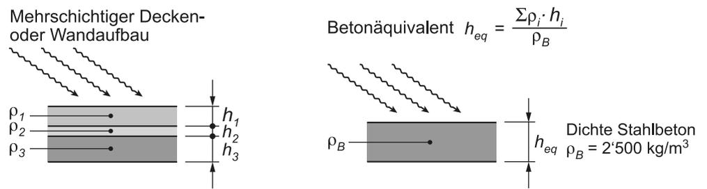
Abbildung 6: Betonäquivalent
