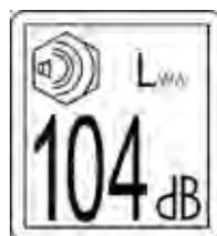
Das LWA-Kennzeichen zeigt den maximalen Schallleistungspegel an.
