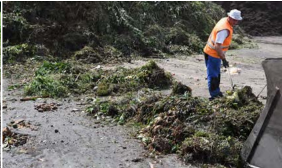
Foto 1.2: Mitarbeiter der Anlagen entfernen möglichst viele Fremdstoffe vor der Verarbeitung, welche eine Fleissaufgabe!
