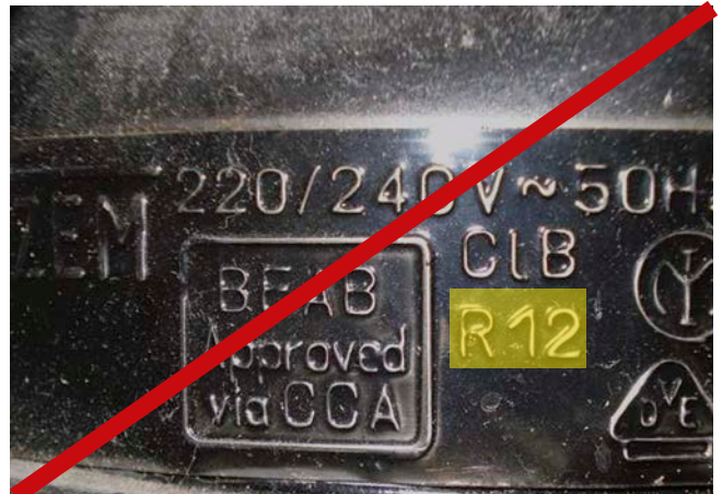
Kältekompressor mit verbotenem Kältemittel R12
