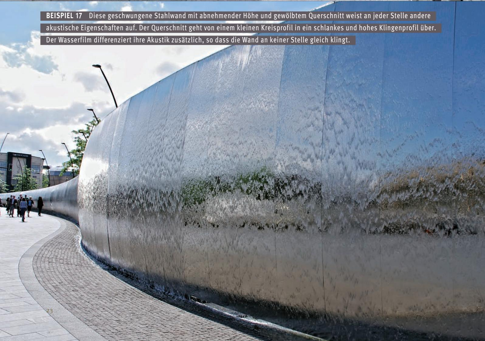
**BEISPIEL 17** Diese geschwungene Stahlwand mit abnehmender Höhe und gewölbtem Querschnitt weist an jeder Stelle andere akustische Eigenschaften auf. Der Querschnitt geht von einem kleinen Kreisprofil in ein schlankes und hohes Klingprofil über. Der Wasserfilm differenziert ihre Akustik zusätzlich, so dass die Wand an keiner Stelle gleich klingt.
