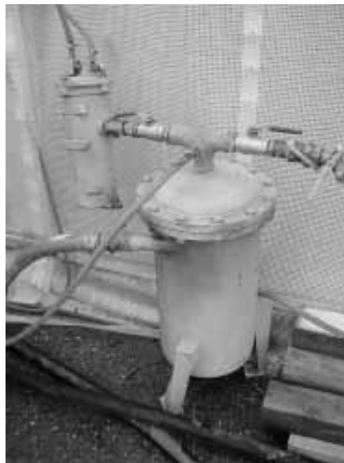
Bild 4: Öl- und Wasserabscheider.
